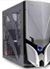
É um componente de hardware com um formato caixa ou invólucro, dentro dela estão fixados a placa mãe os drives, CD, HD e DVD memórias placas de vídeo som, scanner, rede, modem, dentre outras.
